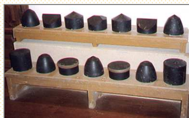
Piezas polares del electroimán gigante de Blas Cabrera procedentes de la Universidad de Zaragoza. En préstamo en el Museo Elder de la Ciencia y la Tecnología de Las Palmas de Gran Canaria.
