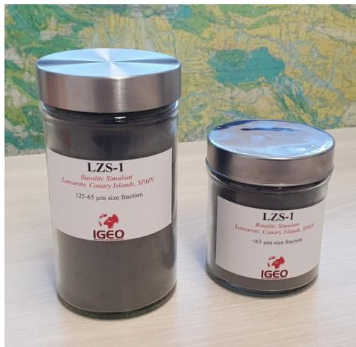
*Fig. 20: Primer simulante regolítico español fabricado en el IGEO (CSIC-UCM) a partir de material basáltico de Lanzarote.*
